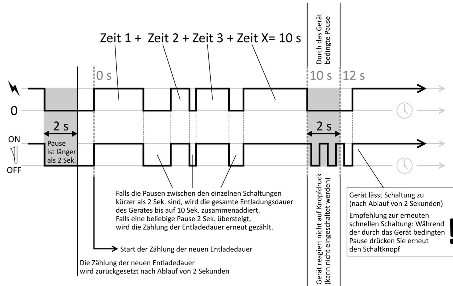
Die Entladezeit bei diesem Gerät beträgt max. 10 s. Danach schaltet das Gerät automatisch ab. Es kann frühestens nach 2 s durch Loslassen und wieder Betätigen den Schaltknopf für eine erneute Entladung aktiviert werden.
